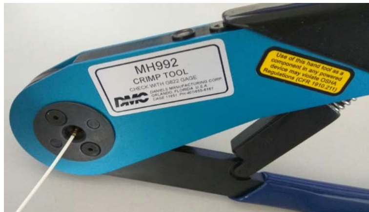
图 D.6 导线压接示意图
