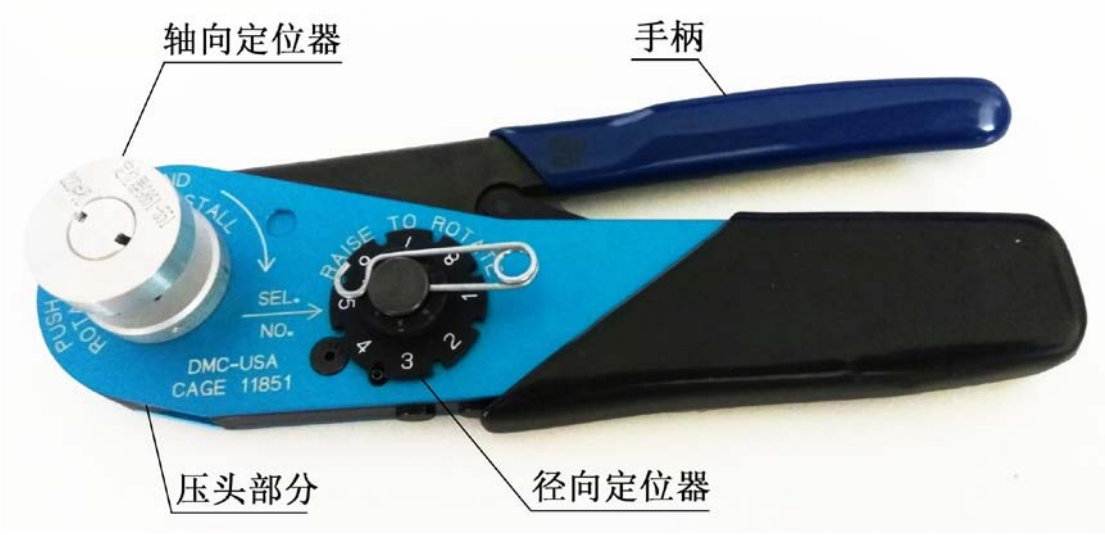
图D.1 压接钳（以M22520/1-01为例）
