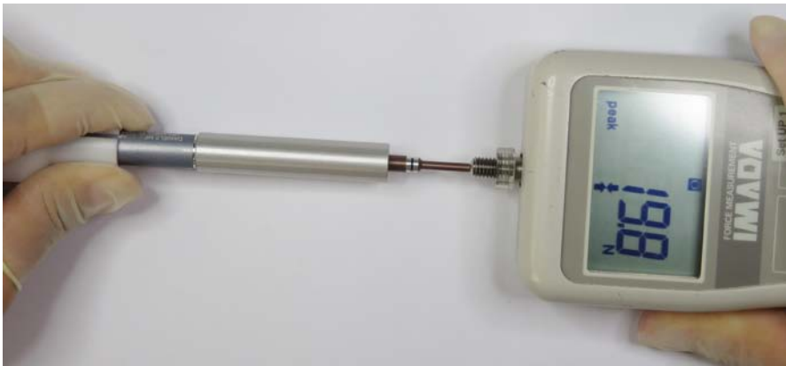
图F. 5 专用测试工具调试保持力的示意图
