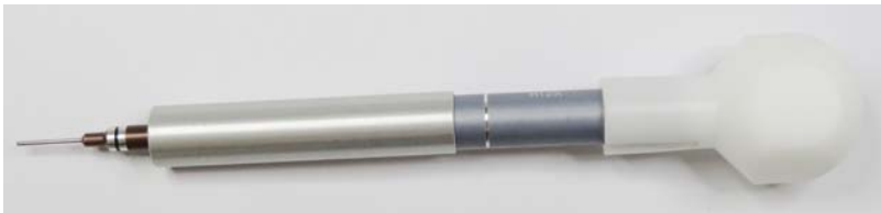
图F. 3 插孔接触件保持力测试工具
