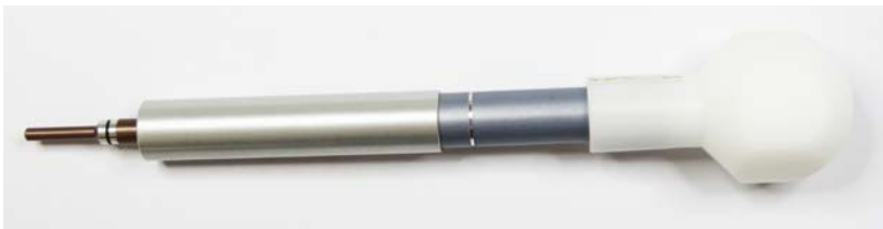
图F. 2 插针接触件保持力测试工具
