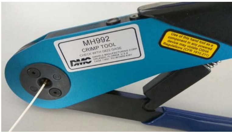
图D.6 导线压接示意图
