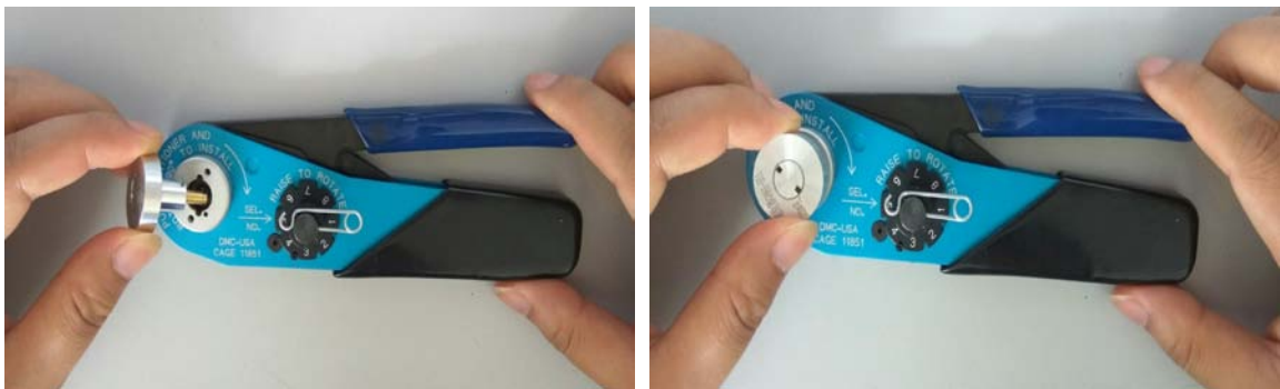
图D. 2 轴向定位器安装示意图
