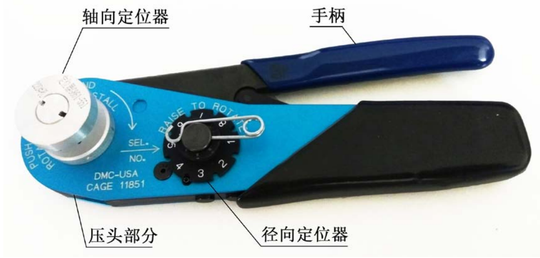
图D.1 压接钳（以M22520/1-01为例）
